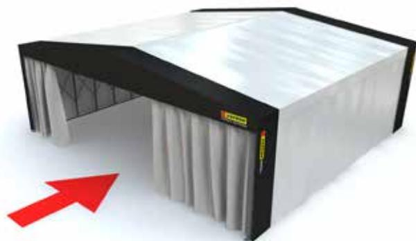
La copertura è realizzata con robusto telo di poliestere bispalmato di PVC con un trattamento autoestinguente classe 2, del peso di 900 g/m<sup>2</sup>.
