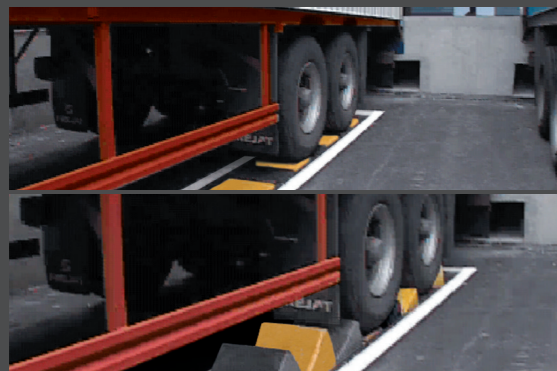
SYSTEME K1 BLOCK POUR LE BLOCAGE DES ROUES DU VEHICULE K1 BLOCK SYSTEM, ZUM BLOCKIEREN DER RÄDER DES FAHRZEUGS
